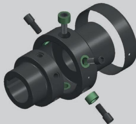
Dibujo de despiece del acoplamiento flexible compacto
