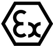
L'accouplement DSS/SG/RF peut être fourni conforme à la directive 2014/34/UE (ATEX) relative aux appareils et systèmes de protection destinés à être utilisés dans une atmosphère potentiellement explosive. Sur le moyeu, il est pratiqué un marquage conformément à la directive ; respecter les instructions de montage, les contrôles périodiques comme il est décrit dans le manuel d'utilisation et d'entretien qui accompagne le dispositif.
