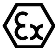
Il dispositivo DSS/SG/RF con foro finito e cava può essere fornito conforme alla direttiva 2014/34/UE (ATEX) relativa agli apparecchi e sistemi di protezione destinati ad essere utilizzati in atmosfera, potenzialmente esplosiva. Sul mozzo viene eseguita una marcatura come prescritta dalla direttiva occorre attenersi alle indicazioni di montaggio, controlli programma come descritto nel manuale d'uso e manutenzione fornito assieme al dispositivo.
