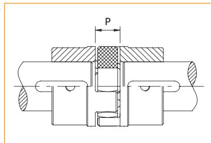
Nel caso di fissaggio con calettatori, serrare le relative viti progressivamente fino al raggiungimento della coppia di serraggio indicata a catalogo, rispettando una sequenza di tipo a croce.
