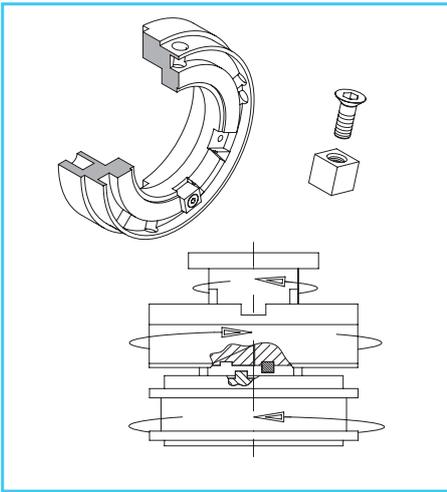
**.../AM: Überlastkupplung mit mechanischem Anschlag zur Begrenzung des Drehwinkels, synchron wiedereinrastend**
