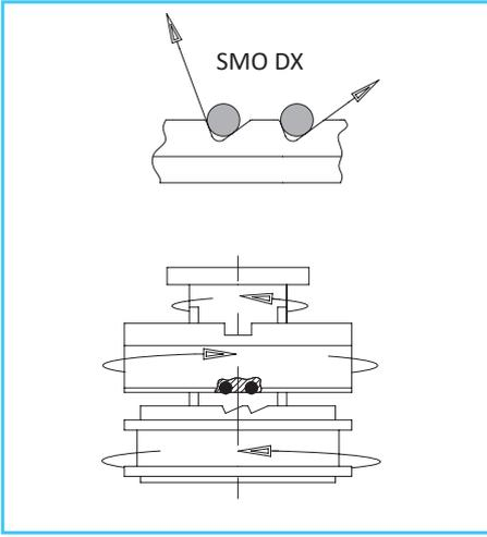
**.../SMO: Überlastkupplung mit unterschiedlichen Überlastmomenten bei Rechts- und Linkslauf.**
