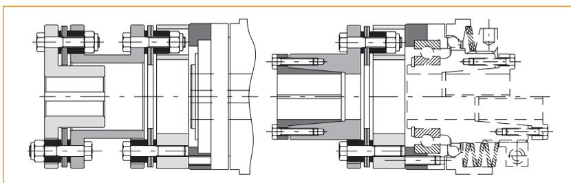
Soluzione con adattatori sia in versione semplice che doppia, per una semplice sostituzione dei pacchi lamellari senza spostare i mozzi (conforme con la direttiva API610).
