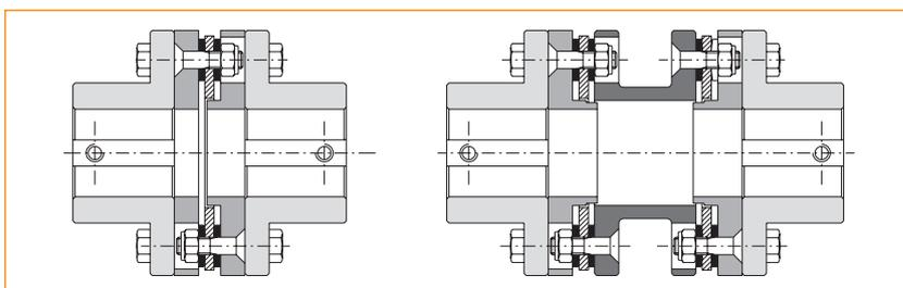
Soluzione per il montaggio in verticale dove lo spaziatore (GTR/D) o l'allunga (GTR/DBSE) deve essere supportato in modo da evitare che il proprio peso gravi sul pacco lamellare.
