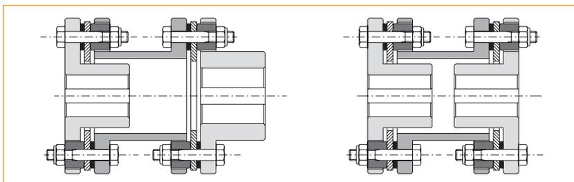
Esecuzione in abbinamento ai limitatori di coppia della linea /SG con semplice e/o doppio pacco lamellare.
