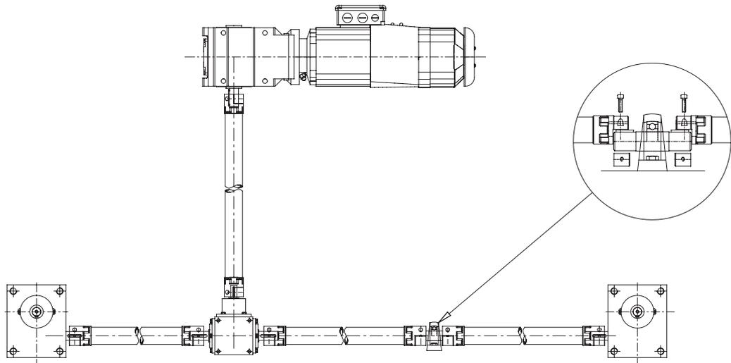
Nel caso di elevato DBSE combinato con alta velocità, potrebbe essere necessario utilizzare un albero intermedio con supporto e cuscinetto. Consultare il nostro ufficio tecnico.
