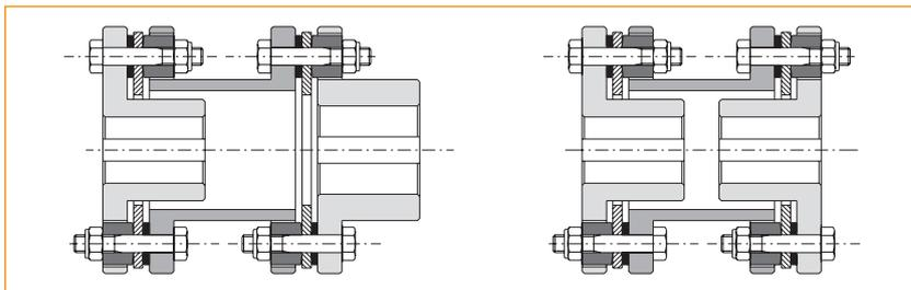
Exécution associée aux limiteurs de couple de la ligne / SG avec pack de lamelles simple et/ou double.
