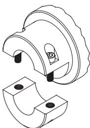
Réduction des jeux angulaires et facilité de montage/démontage radial.
